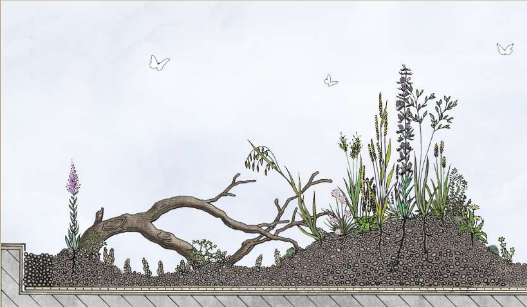
Coupe de principe (hors-échelle) d'une toiture végétalisée extensive, Source : ZHAW, Institut für avec micro-topographie et bois sec pour les insectes. Umwelt und Natürliche Ressourcen.
